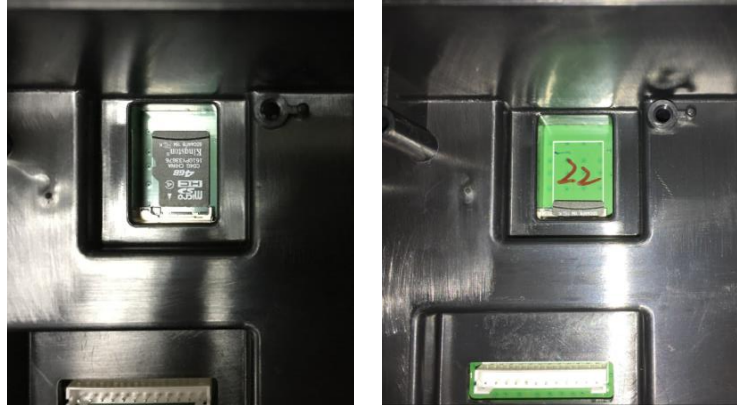
Figure 2-5 coulant une carte SD dans la fiche SD (gauche); carte SD installée (droite).
