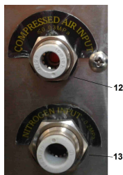
Widok złącz do podłączenia sprężonego powietrza i mieszanki gazowej MAP (dotyczy pakowarek w wersji GAS umożliwiające pakowanie w atmosferze modyfikowanej MAP).
